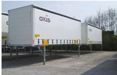
Abbildung 14 - Wechselbrücke<sup>7</sup>
